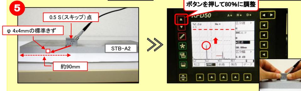
左上の「」キーを押し、エコー高さを80%の高さに調整する。
