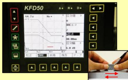
図を参照してSTB-A2試験片を裏返し、上から約35mm、左から約180mmの位置にマシン油を塗布する。
