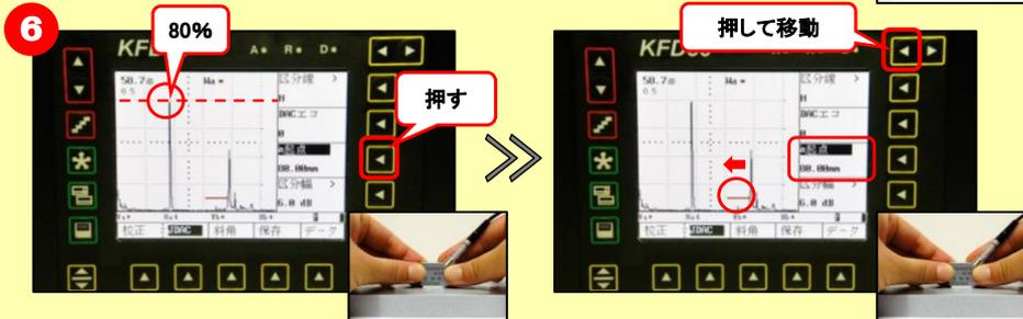
項目選択キーの「a起点 」キーを1回押す。「」キーでゲートを0.5Sエコーに移動する。
