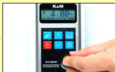
接触媒質(カプラント)を塗布した零点調整用試験片にプローブを接触させ、「V」キーを押す。
