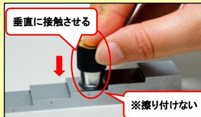
測定物と同じ材質で厚さが既知の試験片を準備する。試験片に接触媒質(カプラント)を少量塗布し、プローブを接触させる。
