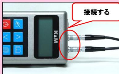
KT-200(上部コネクタ)と探触子(プローブ)をケーブルで接続する。
